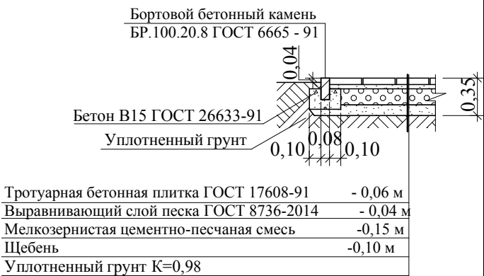
Конструкция тротуарного покрытия из тротуарной плитки Тип 2
