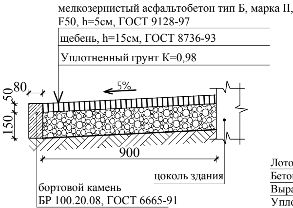
Конструкция отмостки Тип 5
